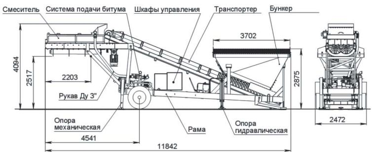
Установка выполнена в виде передвижного (на колесной оси) агрегата, состоящего из следующих основных агрегатов:
