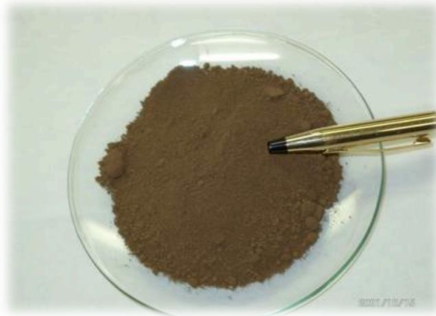
Рис. 4. Внешний вид порошка Мультигрейд
