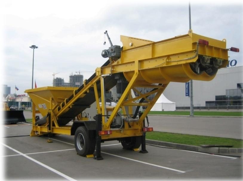
Рис. 6. Мобильная Установка Холодного Асфальтобетона МУХА
