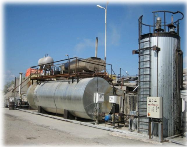
Рис. 5. Смеситель для приготовления вяжущего Мультигрейд промышленного типа
