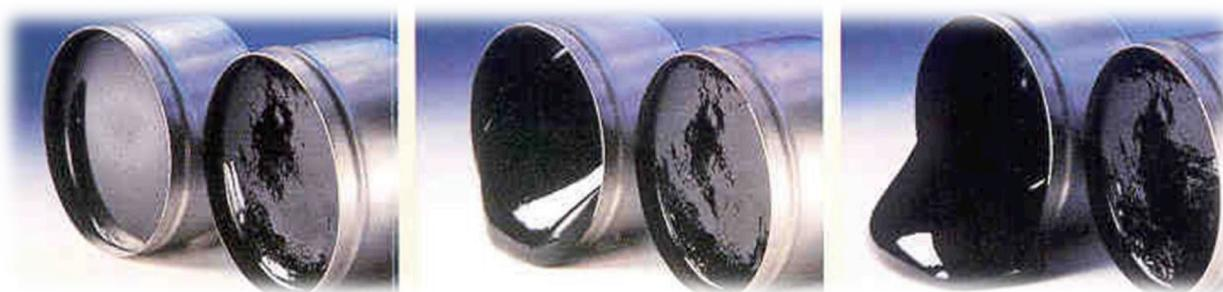
Рис. 1. Сравнение поведения обычного битума и битума Мультигрейд при комнатной температуре.
