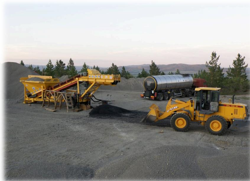
Рис. 7. Участок приготовления холодной смеси Мультигрейд при помощи смесителя МУХА
